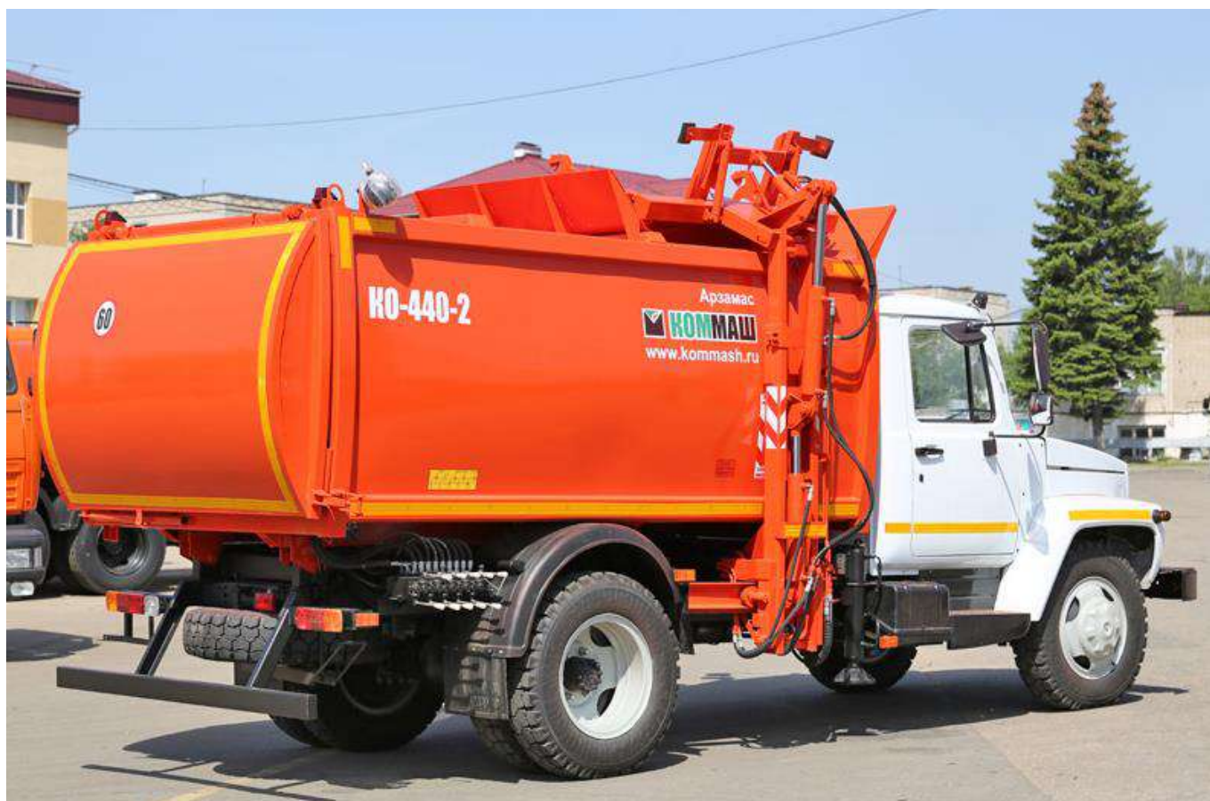
Рисунок 4.10.3 – Мусоровоз ГАЗ КО-440/2 на базе ГАЗ-3309
