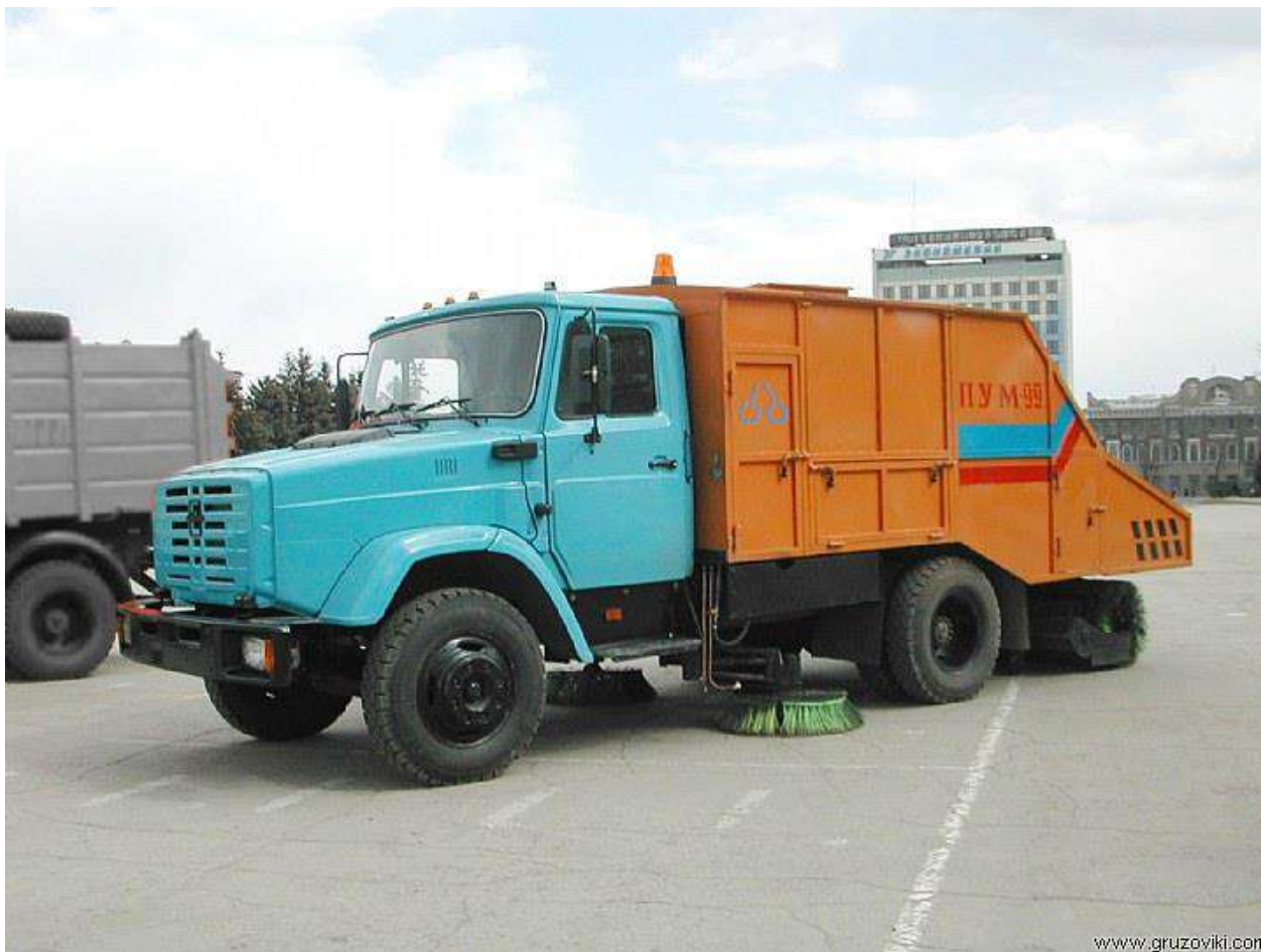
Рис. 6.3.1 – Подметально-уборочная машина ПУМ-99 (ПУМ) на базе ЗиЛ-4333
