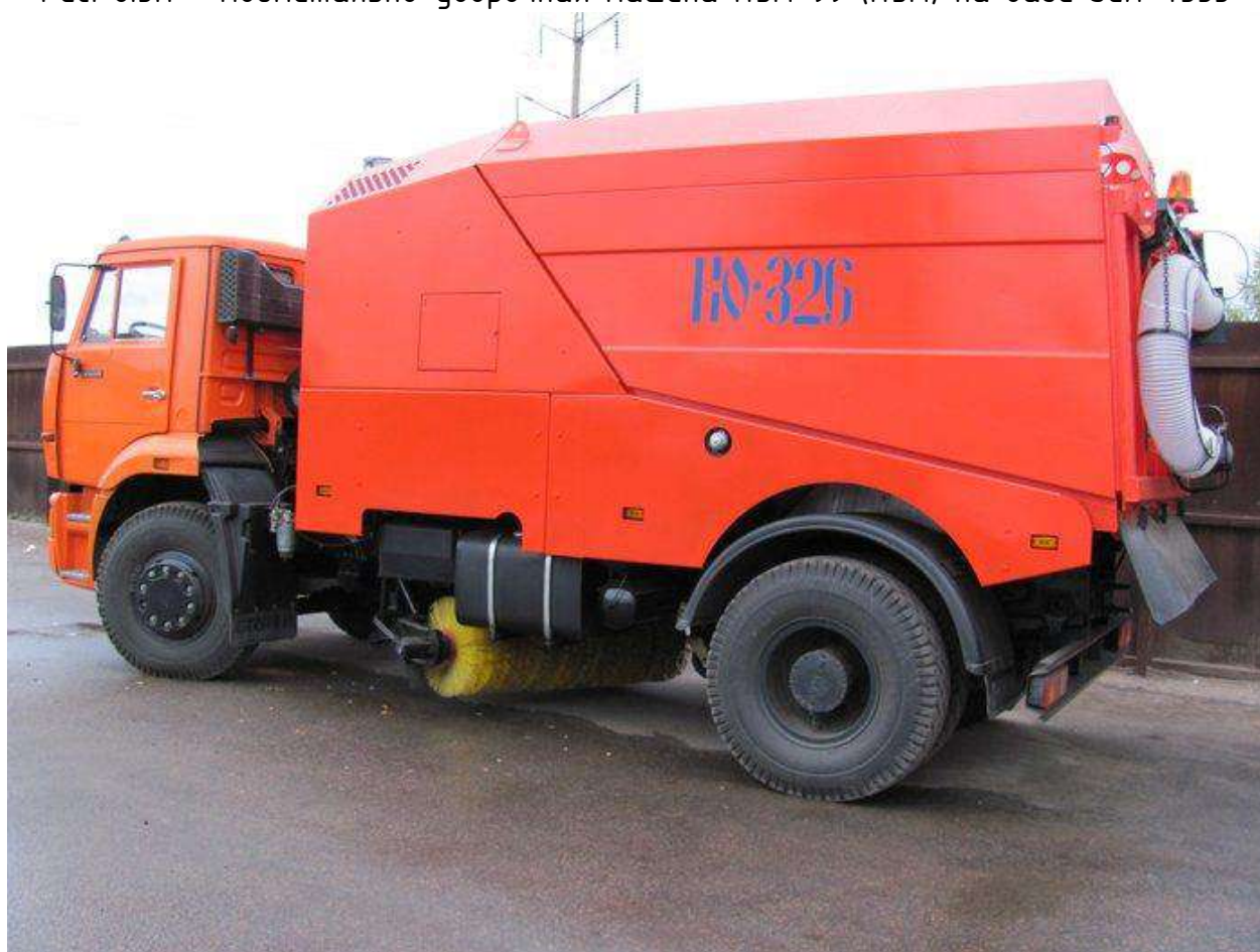
Рис. 6.3.1 – Подметально-уборочная машина ПУМ-99 (ПУМ) на базе ЗиЛ-4333
